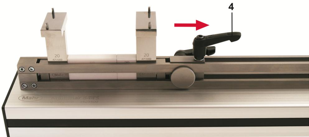
**7.3 Anlegen der Spanneinheit und Klemmen mit seitlichem Klemmhebel 3**
