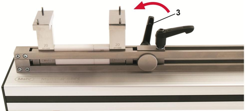
**7.4 festes Verspannen der Planschenkel-Endmaßkombination durch Anziehen der Exzenterklemmung mit Spannhebel 4**
